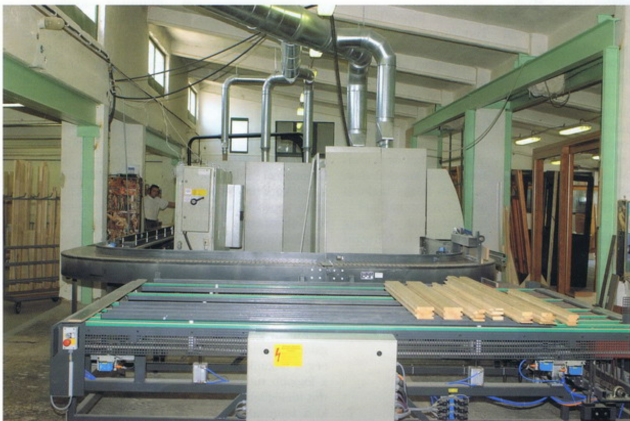
A Weinig Unicontrol 12 szerszámcserével készíti az ablakokat.
